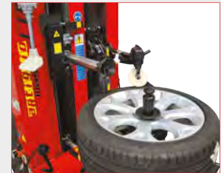
Automatické nastavení nástroje v automatickém cyklu
