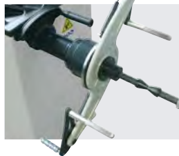
GAR181 Univerzální příruba pro upínání motocyklových kol s hřídelem Ø 14mm, upínací kruhovou maticí, 2 kuželů a 6 distančními kroužky.
