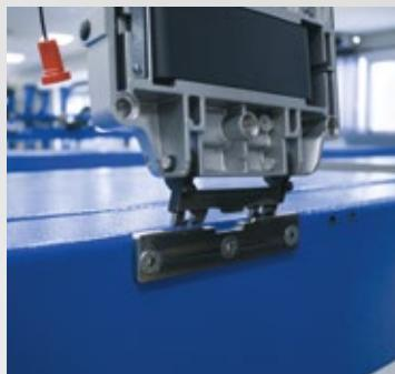
Perforovaná platforma pro držáky měřicích hlav Ravaglioli 3D geometrie kol (Pouze pro modely .2, .3, .5).
