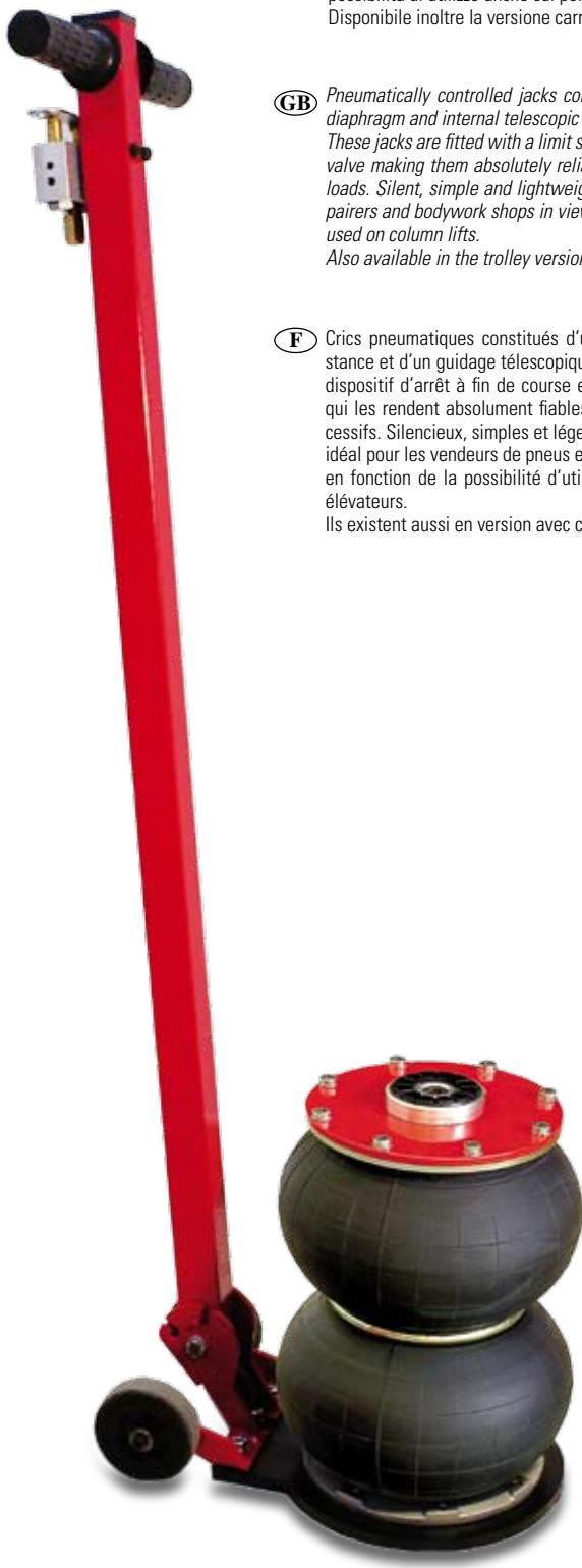
**I** Sollevatori pneumatici costituiti da una membrana ad alta resistenza e da una guida telescopica interna. Sono dotati di un dispositivo d'arresto a fine corsa e di una valvola di sicurezza che li rendono assolutamente affidabili in caso di carichi eccessivi. Silenziosi, semplici e leggeri, rappresentano il prodotto ideale per gommisti e carrozziere in funzione della possibilità di utilizzo anche sui ponti sollevatori. Disponibile inoltre la versione carrellata.
