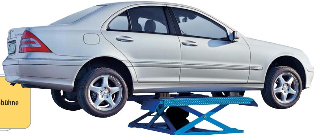
Il classico sollevatore per gommisti, a funzionamento completamente pneumatico, facilmente installabile sia in interni che in esterni. Rampe di salita mobili per consentire le operazioni di equilibratura a ruota montata. Dispositivo di aggancio meccanico ad inserimento automatico per assicurare la stabilità durante l'esercizio. Valvola di massima pressione a garanzia nei confronti di sovraccarichi.
