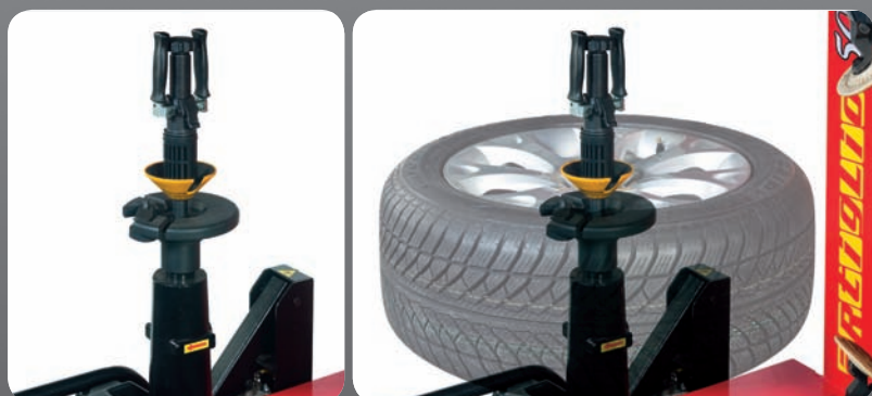
Procedura demontáže horní patky pneumatiky.
