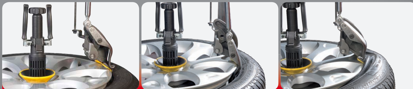
Procedura demontáže horní patky pneumatiky.
