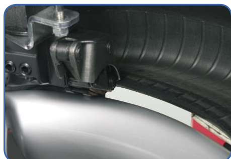
› Standardní procedura demontáže dolní patky pláště montážní/demontážní hlavou
