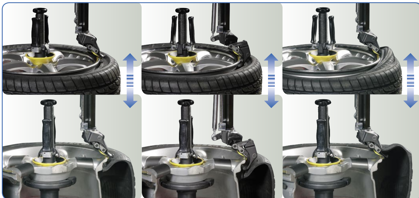
› Demontáž horní strany pneumatiky.
